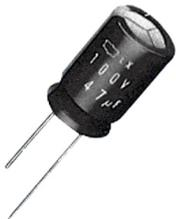
In der Technik werden Kondensatoren zur Zwischenspeicherung von Ladung verwendet; häufig werden sie als *Rollkondensatoren* ausgeführt; dabei werden zwei sehr dünne Metallfolien durch einen dünnen Nichtleiter getrennt aufgewickelt. Gegenüber dem ebenen Plattenkondensator ergibt sich neben der kompakten Bauweise der Vorteil, dass die Kapazität  $C$  um den Faktor 2 vergrößert ist, da sich beim Rollkondensator Vorder- und Rückseiten der Folien paarweise gegenüberstehen.
